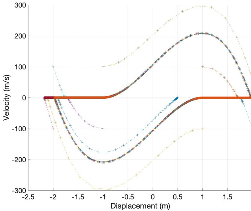
Figure 9: Velocity - displacement graph: Van der Pol equation:  $\ddot{x} + \mu(x^2 - 1)\dot{x} + x = 0$ ;  $x(0) = x_0$ ,  $\dot{x}(0) = \dot{x}_0$ ;  $\mu = 160$ ; for initial conditions:  $(0.5, 0.0)$ ;  $(1.0, 100.0)$ ;  $(1.0, -100.0)$ ;  $(2.0, 100.0)$ ;  $(2.0, -100.0)$ ;  $(-1.0, 100.0)$ ;  $(-1.0, -100.0)$ ;  $(-2.0, 100.0)$ ;  $(-2.0, -100.0)$ ;  $\Delta t = 0.001$  seconds
